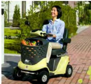
セニアカーは、買い物や散歩など日常の移動手段としてご利用頂ける「ハンドル形電動車いす」です。動くスピードは最高で時速6kmと早足の速さとはほぼ同じ。充電した電気を使い、モーターで動くため、音も静かで、まるで歩くように外出を楽しむことができます。
